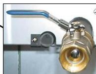
Válvula de vaciado del aceite.
