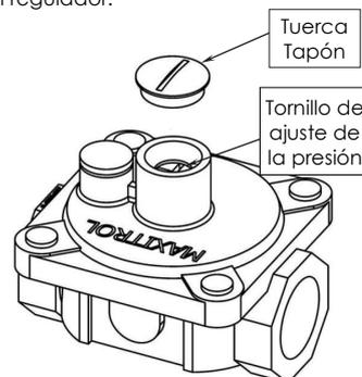
**NOTA:** Mida la presión de funcionamiento en el punto de prueba de salida de la válvula de control de gas con el quemador en funcionamiento.
