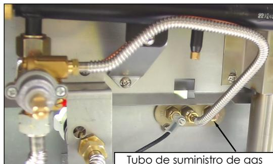
2. Retire los inyectores del piloto y sustitúyalos por inyectores piloto del tamaño correcto según se indica en las "Tablas de especificaciones del gas" al final de esta sección.
